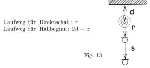
Das Hallmikrophon ist demnach im Abstand s $=2d=10\ m$ vom Hauptmikrophon aufzustellen, oder bei nur einem Mikrophon sollte die Verspätung durch die Zwischenaufnahme  $t=2d/c=30\ ms$  betragen.
