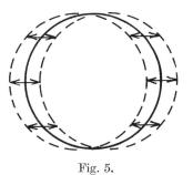
Das Geschwindigkeitspotential eines Strahlers erster Ordnung kann man dadurch erhalten, dass man den Strahler nullter Ordnung in B, mit Geschwindigkeitspotential  $\Phi^B_o$  einem um ds versetzten gleichartigen Strahler in A, mit Potential  $\Phi^A_o$  gegenphasig überlagert. Im Aufpunkt P gilt dann:
