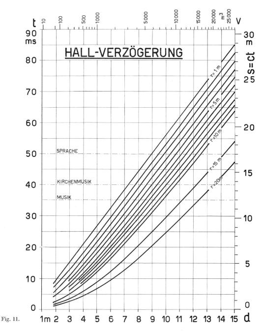
Da bei derart grosser Verzögerung der Halleinsatz getrennt vom Primärschall empfunden wird, kann die entstehende Lücke überbrückt werden durch eine etwa mit 30...35 ms verspätete, isolierte Wiederholung des Direktschalles (durch zusätzlichen Abhörkopf am Magnetton-Verzögerungsgerät). Diese Massnahme entspricht den realen Verhältnissen zeitlicher Trennung zwischen Eintreffen des ersten Rückwurfes und eigentlichem Halleinsatz.
