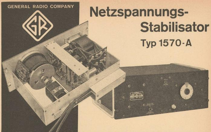
Dieser servo-mechanische Spannungs-Schnellregler besteht im wesentlichen aus einem motorangetriebenen, kugelgelagerten Variac-Regeltransformator kleinerer Leistung, einem Stufentransformator mehrfacher Leistung, einer Steuereinheit und dem Servomotor, der durch automatische Einstellung des Variacs die Ausgangsspannung konstant hält.
