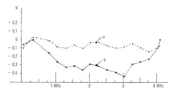
Fig. 16. Frequenzgang der Koaxialleitung Zürich-Lugano
