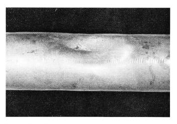
Fig. 14. Einbuchtung des Kabels durch Explosionsdruck bei Blitzeinschlag
