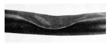
Fig. 2. Eingedrücktes Koaxialkabel Cavo coassiale schiacciato
