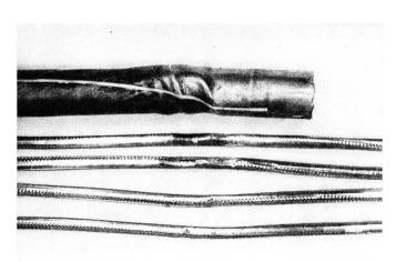
Fig. 5. Durch Verdrehung (markiert durch weisse Linie) zerstörtes Kabel mit den entsprechenden Schäden der Rohre Torsione (marcata dalla linea bianca) del cavo e dei tubi interni
