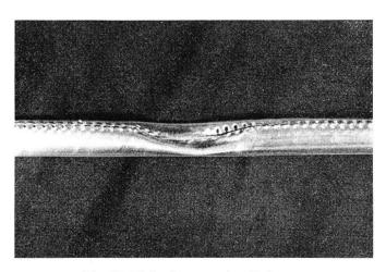
Fig. 15. Einbuchtungen eines Rohres Schiaceiamento di un tubo
