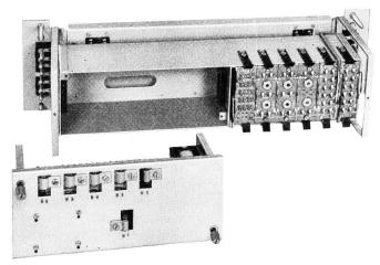
Fig. 11. Breitbandverstärker von hinten, Verstärkereinsatz herausgenommen
