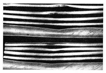
Fig. 3. Eingedrückte Koaxialkabel mit den entsprechenden Einbuchtungen an den Rohren Avarie dei tubi coassiali causate da schiacciamenti del cavo
