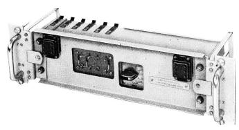
Fig. 10. Breitbandverstärker ohne Abdeckhaube und ohne Abdeckblech von vorn
