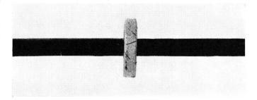
Fig. 9. Deutlich sichtbare Verunreinigungen (Späne) auf einer Isolierscheibe Impurità (trucioli) visibili su un disco isolante
