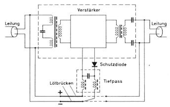
Fig. 5. Gleichstromspeisung des Verstärkers
