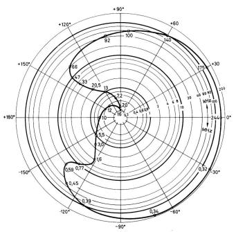
Fig. 6. Niquistdiagramm des Verstärkers
