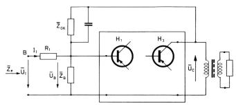
Fig. 3. Schaltbild zur Berechnung der Eingangsimpedanz
