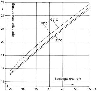
Fig. 8. Gleichstromcharakteristik
