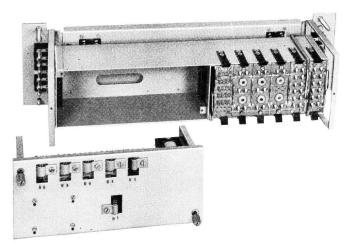
Fig. 11. Breitbandverstärker von hinten, Verstärkereinsatz herausgenommen
