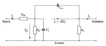
Fig. 4. Ersatz-Schaltbild eines Transistors
