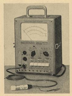
Röhrenvoltmeter Type URU 10 Hz-1000 MHz, mit Tastkopf
