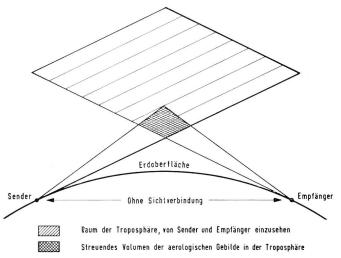
Fig. 8. Schematische Darstellung des Scattering- oder Streustrahleffekts
