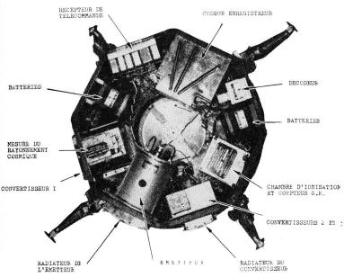
Fig. 5. Aspect intérieur du satellite Pionier V
