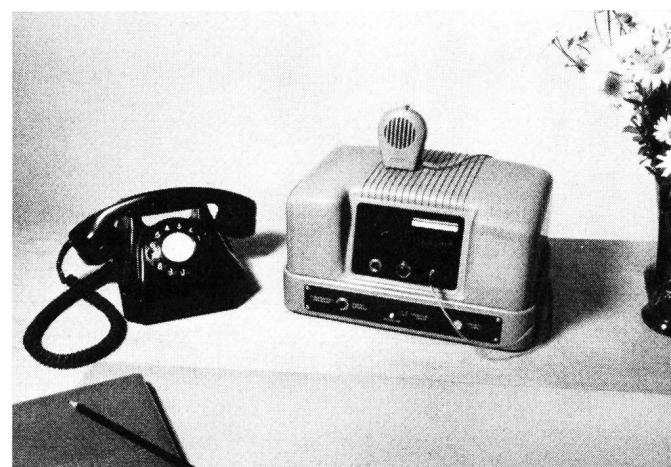
Fig. 5. Zusatzgerät zum Telephon für die Entgegennahme von Meldungen bzw. für das Erteilen von Auskünften bei Abwesenheit des Abonnten
