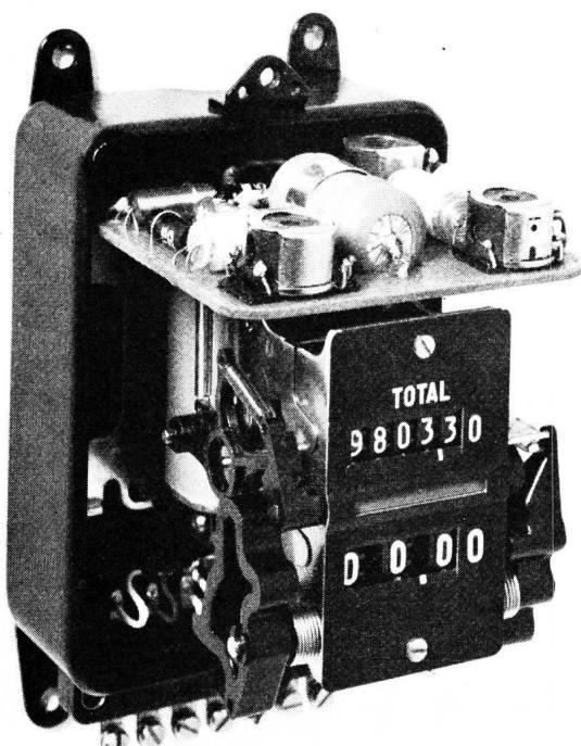
Fig. 5. Taxmelder mit bisherigem Mechanismus und elektronischem Zusatz
