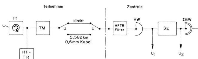
Fig. 9. Schaltungsanordnung für Betriebsversuch
