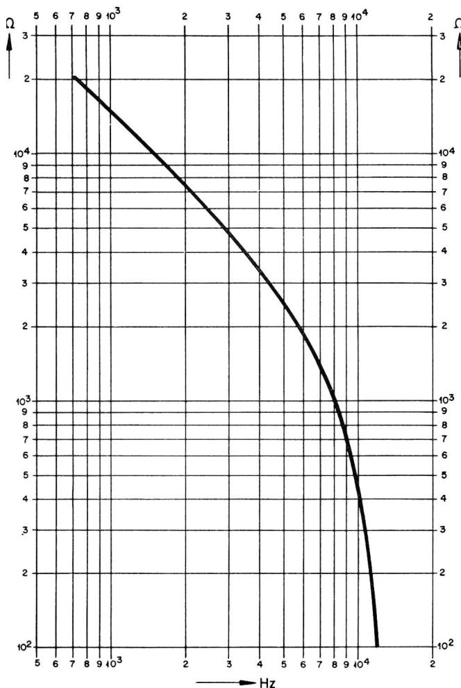
Fig. 12. Impedanzverlauf des 12-kHz-Taxmelders
