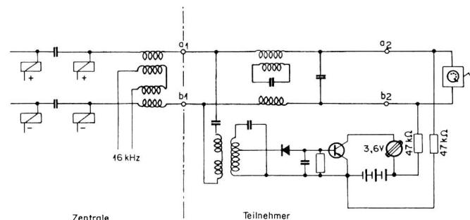
Fig. 10. Schaltungsanordnung für den Akkumulatordauerversuch
