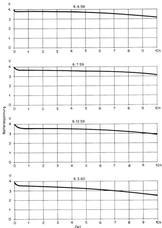
Fig. 11. Entladekurven während des Dauerversuches
