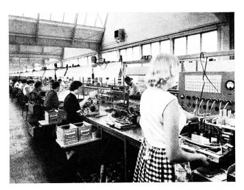
Fig. 3. In langen Reihen sitzen in dem auf das modernste eingerichtete Fernsehwerk Hunderte von Arbeiterinnen und Arbeiter an langen Werktischen und fügen aus den Einzelteilen die Geräte zusammen. Die Fabrikation wird immer wieder durch vollautomatische Prüfgeräte überwacht, die – wie das im Vordergrund sichtbare – beim kleinsten Fehler eine Kontrollampe auf dem Anzeigetableau aufleuchten lassen und so allfällige Mängel feststellen helfen
