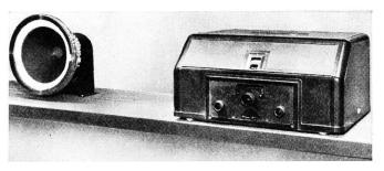
Fig. 1. Vor dreissig Jahren sah ein moderner Radioempfänger so aus. Der hier gezeigte S 35, mit vier Röhren und separatem dynamischen Lautsprecher, war damals eine bahnbrechende Entwicklung, die noch jahrelang Vorbild blieb
