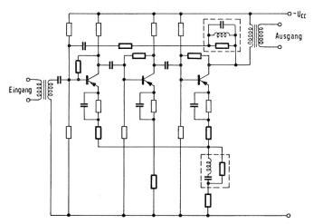
Fig. 32. Trägerfrequenzverstärker mit kombinierter G. K.
