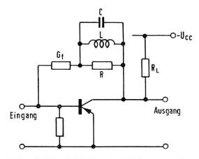
Fig. 41. Parallel-Parallel-G. K. mit Anhebung der Verstärkung bei hohen Frequenzen
