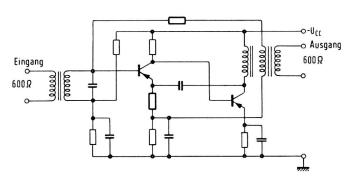
Fig. 27. Parallel-Parallel-G. K. über zwei Stufen in Emitterschaltung mit Transformator
