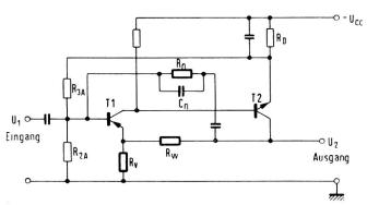
Fig. 40. Transistorverstärker mit hoher Eingangsimpedanz [18].
