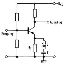
Fig. 43. Serie-Serie-G. K. mit Serieresonanzkreis parallel zu  $R_f$
