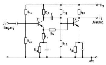
Fig. 26. Serie-Parallel-G. K. über zwei Stufen durch  $R_r$  und  $R_w$
