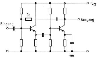
Fig. 28. Parallel-Parallel-G. K. über zwei Stufen, mit Kollektorschaltung in der ersten Stufe
