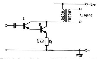
Fig. 35. Darlington-Schaltung mit Serie-Serie-G. K. durch  $R_f$  [16]
