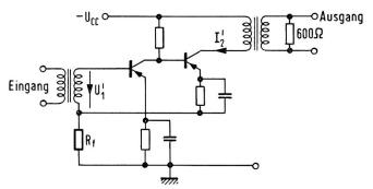
Fig. 30. Serie-Serie-G. K. über zwei Stufen in Emitterschaltung
