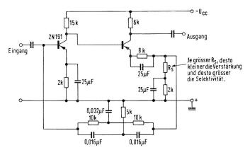
Fig. 44. G. K.-Verstärker mit Bandfiltercharakteristik (Doppel-T-Glied für  $1000~\mathrm{Hz}$ )
