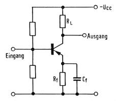
Fig. 42. Serie-Serie-G. K. mit Anhebung bei hohen Frequenzen
