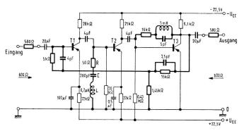
Fig. 33. Breitbandverstärker (2 kHz...1 MHz) mit Parallel-Parallel-G. K. über drei Stufen [13]
