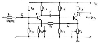
Fig. 25. Parallel-Serie-G. K. über zwei Stufen in Emitterschaltung durch  $R_s$  und  $R_T$ .
