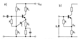
Fig. 39. Positive Rückkopplung zur Reduktion des Einflusses der Widerstände  $R_2$  und  $R_3$  [6]. a) Gleichstrom-Schaltung; b) wechselstrommässige Ersatzschaltung
