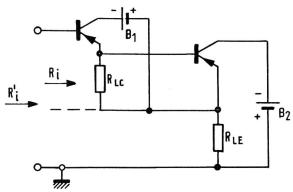
Fig. 37. Verstärker mit hohem Eingangswiderstand [17], Prinzipschema
