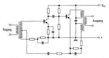
Fig. 46. Verstärker mit G. K. über Transformatorbrücken für Trägerfrequenztelephonie [25]
