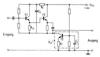
Fig. 38. Verstärker mit hoher Eingangsimpedanz nach dem Prinzip von Fig. 37
