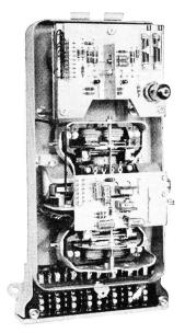
Fig. 2. Transistorisierter Drehmomentgeber für Fernmessung
