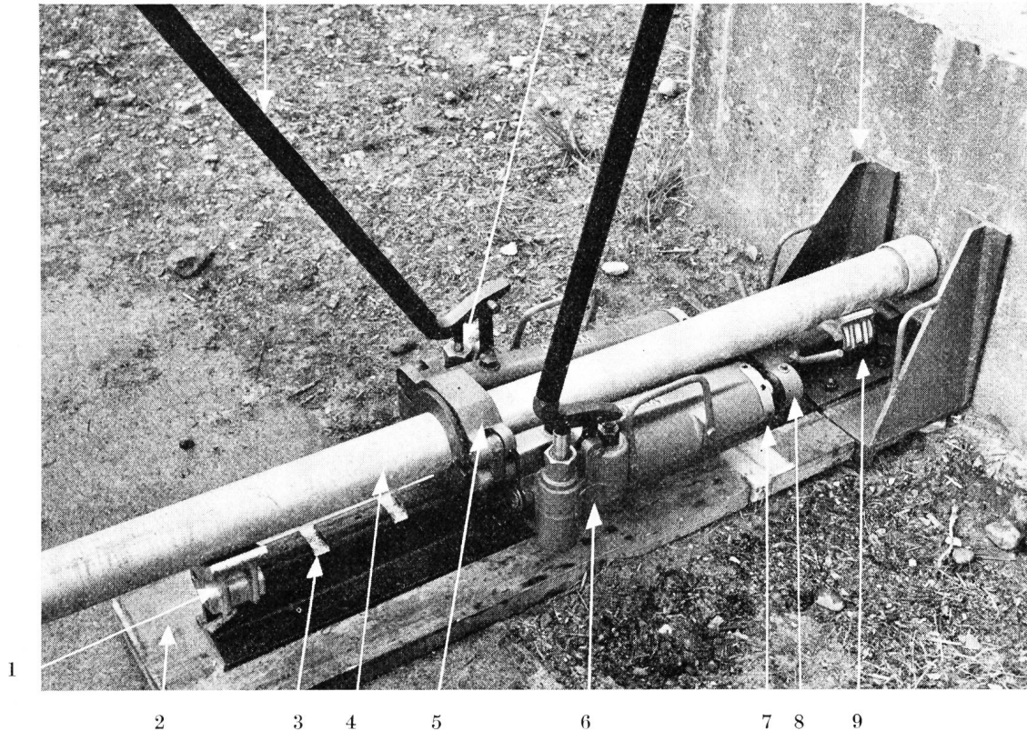
Fig. 2. Hydraulisch zu betätigende Röhren-Stosswinde mit eingelegtem Rohr – Pousse-tubes hydraulique avec tuyau mis en place
