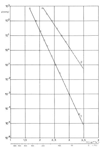
Fig. 1. Dampfdruckkurven von:  $1\ Di-n-butylphthalat$ 2 Benzylalkohol
