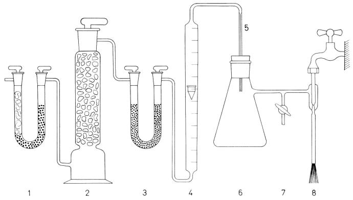
Fig. 3. Apparatur zur gravimetrischen Bestimmung kleiner Dampfdrucke
