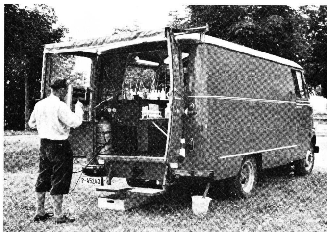
Fig. 4. Das über die offene Kastentüren gespannte Vordach dient nicht nur als Wetterschutz, sondern auch als Verstrebung. Beide Türflügel sind mit je einem Aufklapptischchen versehen. Das Tischchen links, das mit einem hitzebeständigen Material belegt ist, trägt einen Trockenschrank der mit Butagas oder, wie auf dem Bild, mit einem Azetylenbrenner betrieben wird. Auf dem Boden steht ein Kessel unter dem Ablaufrohr des Brunnentrogges
