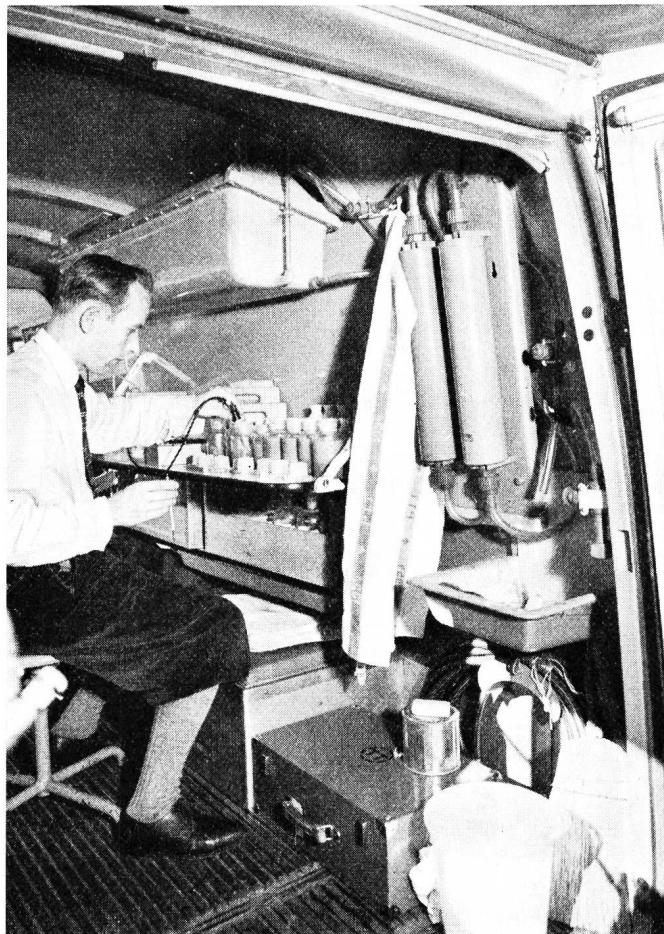
Fig. 3. In der Dachwölbung erkennt man den Wassertank aus Kunststoff, der über den 2-Säulen-Ionenautauscher im Vordergrund gefüllt wird. Unter dem Wasserentsalzer sieht man auch einen kleinen Brunnentrog aus Polyester. Die aufklappbare Tischplatte und das darunter befindliche Tablar dienen als Abstellflächen und als zusätzlicher Arbeitsplatz. Quer zum Profil des Bodenbelages aus Gummi ist noch eine der TT-Schienen zur Befestigung schwerer Geräte sichtbar.
