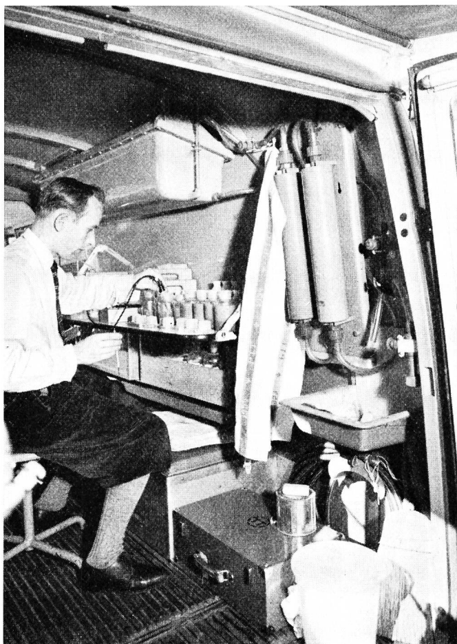
Fig. 3. In der Dachwölbung erkennt man den Wassertank aus Kunststoff, der über den 2-Säulen-Ionenaustauscher im Vordergrund gefüllt wird. Unter dem Wasserentsalzer sieht man auch einen kleinen Brunnentrog aus Polyester. Die aufklappbare Tischplatte und das darunter befindliche Tablar dienen als Abstellflächen und als zusätzlicher Arbeitsplatz. Quer zum Profil des Bodenbelages aus Gummi ist noch eine der TT-Schienen zur Befestigung schwerer Geräte sichtbar
