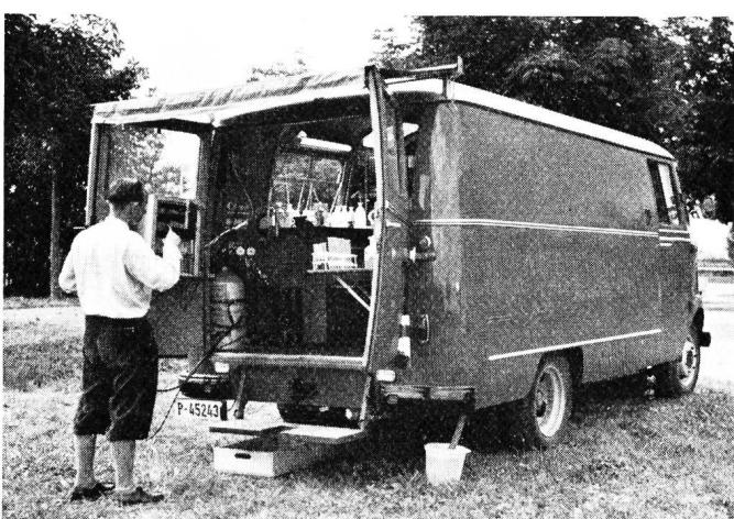
Fig. 4. Das über die offene Kastentüren gespannte Vordach dient nicht nur als Wetterschutz, sondern auch als Verstrebung. Beide Türflügel sind mit je einem Aufklapptischchen versehen. Das Tischchen links, das mit einem hitzebeständigen Material belegt ist, trägt einen Trockenschrank der mit Butagaz oder, wie auf dem Bild, mit einem Azetylenbrenner betrieben wird. Auf dem Boden steht ein Kessel unter dem Ablauftrohr des Brunnentroges
