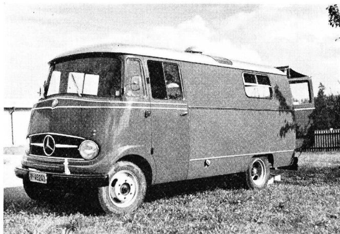
Fig. 1. Frontansicht des Feldlaborwagens Mercedes Typ L 319 D. Die Kastentüren hinten sind geöffnet und mit dem Vordach bespannt
