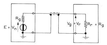
Fig. 2. Collegamento tra generatore e ricevitore nel caso  $R_{\rm g}=R_{\rm r}$ Liaison entre générateur et récepteur dans le cas où  $R_{\rm g}=R_{\rm r}$
