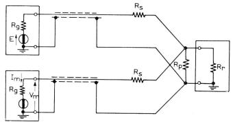
Fig. 21. Influenza fra due generatori: calcolo della riduzione  $V_{\rm m}/E$  nel caso della figura 6a Influence entre deux générateurs: calcul de la réduction  $V_{\rm m}/E$  dans le cas de la figure 6a
