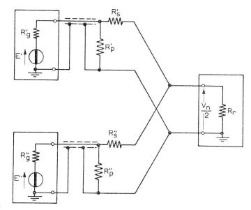
Fig. 16. Antenna fittizia doppia asimmetrica, per due generatori con impedenze di uscita diverse. Caso indeterminato: antenna con quattro resistori
