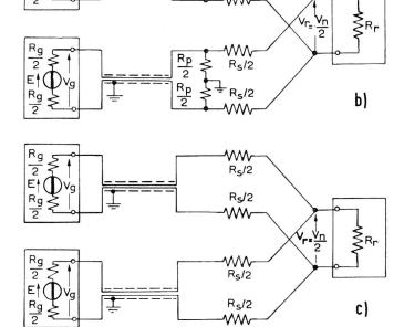
Fig. 7. Antenna fittizia doppia simmetrica, per due generatori con la medesima impedenza di uscita. Generatori e ricevitore tutti bilanciati
