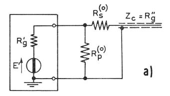
Fig. 12. Adattatore a L in salita, per eguagliare le impedenze di uscita dei due generatori
