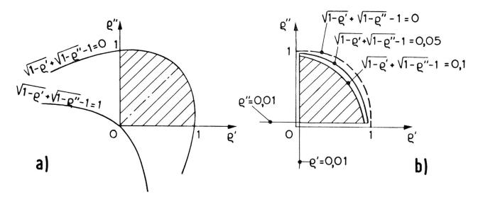
Fig. 10. Campo di validità dei parametri  $\rho'$  e  $\rho''$  (definiti al paragrafo 6.1) nel caso dell'antenna fittizia doppia asimmetrica, per due generatori con impedenze di uscita diverse. (Antenna con tre resistori della figura 9a) a) limiti analitici
