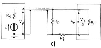
Fig. 5. Antenna fittizia semplice, con generatore sbilanciato e ricevitore bilanciato
