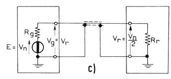
Fig. 3. Antenna fittizia semplice, con generatore e ricevitore entrambi sbilanciati
