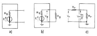
Fig. 1a. Generatore con uscita tarata in tensione a vuoto E
