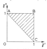
Fig. 11. Campo analitico di validità per γ' e γ" nel caso della medesima antenna fittizia doppia asimmetrica della precedente figura 9a
