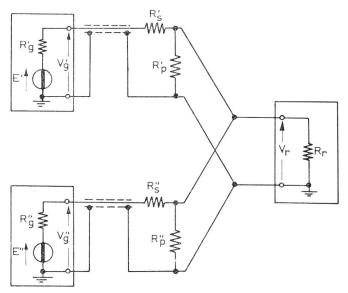
Fig. 19a. Antenna fittizia doppia asimmetrica, per  $\rho'$  e  $\rho''$  (definiti al paragrafo 6.1) minori di 3/4 (comma 6.5.1): è costituita da due sezioni di uguale struttura, con valori diversi degli elementi
