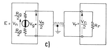
Fig. 4. Antenna fittizia semplice, con generatore e ricevitore entrambi bilanciati
