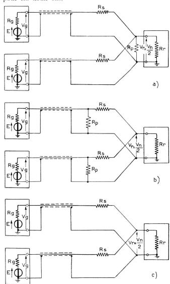
Fig. 6. Antenna fittizia doppia simmetrica, per due generatori con la medesima impedenza di uscita. Generatori e ricevitore tutti sbilanciati
