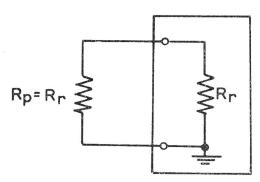
Fig. 9b. Sottocaso particolare ( $\rho' = \rho'' = 0$ ) dell'antenna fittizia doppia della precedente figura 9a Variante ( $\rho' = \rho'' = 0$ ) de l'antenne fictive double de
