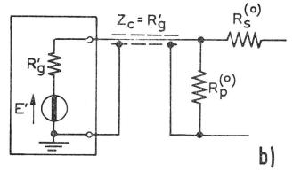
Fig. 12. Adapteur en L «croissant» servant à rendre égales les impédances de sortie des deux générateurs
