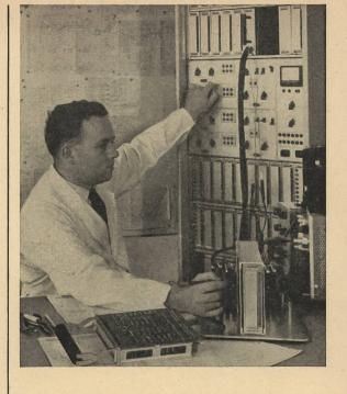
Die Hasler-TOR-Anlagen für die automatische Fehlerkorrektur im drahtlosen Fernschreibverkehr bewähren sich seit Jahren in allen Teilen der Welt. Mit der Schaffung des neuen elektronischen TOR Hasler
