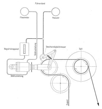
Fig. 9. Messeinrichtung für Kabelzug
