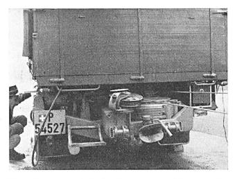
Fig. 8. Lastwagen mit Spill und vorgebautem Flaschenzug für den Kabelzugmesser
