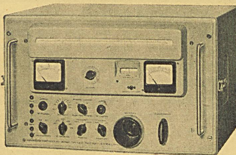
Kurzwellenempfänger Typ EK 07 0,5-30,1 MHz
