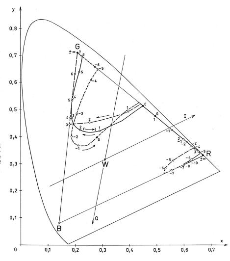
Fig. 6. Einschwingvorgänge im Farbdreieck (Ergebnis der theoretischen Untersuchung). Ausgezogene Kurven: ohne Übersprechen, gestrichelte Kurven: mit Übersprechen. Kurvenparameter:  $\omega_I t$  Übergang Rot  $\rightleftharpoons$  Grün
