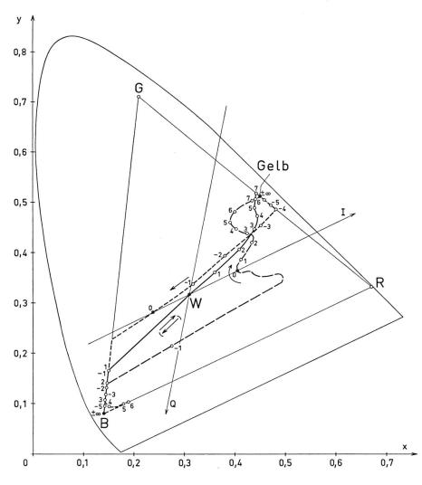
Fig. 5. Einschwingvorgänge im Farbdreieck (Ergebnis der theoretischen Untersuchung). Ausgezogene Kurven: ohne Übersprechen, gestrichelte Kurven: mit Übersprechen. Kurvenparameter:  $\omega_I t$  Übergang Blau  $\stackrel{\sim}{\Rightarrow}$  Gelb
