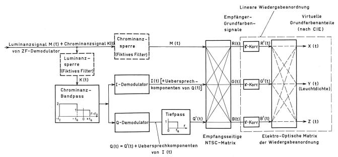
Fig. 2. Blockschema des Farbempfängers (System A) mit idealisierten Filterflanken und linearer Wiedergabeanordnung
