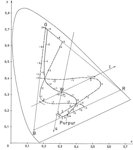
Fig. 4. Einschwingvorgänge im Farbdreieck (Ergebnis der theoretischen Untersuchung). Ausgezogene Kurven: ohne Übersprechen, gestrichelte Kurven: mit Übersprechen. Kurvenparameter:  $\omega_I t$  Übergang Grün  $\rightleftharpoons$  Purpur
