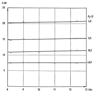
Fig. 25. Kopplungsdämpfung für Schichtkoppler  $B=17.1~\mathrm{mm}$
