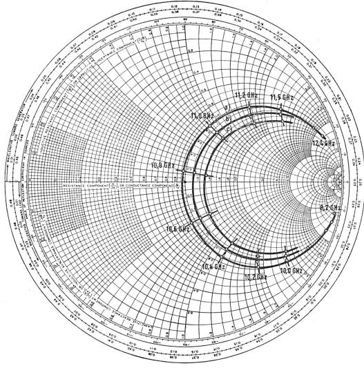
Fig. 35. Impedanz eines Schichtdetektors im X-Band. a) 28  $\Omega$  b) 32  $\Omega$  c) 37  $\Omega$
