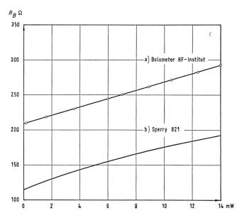
Fig. 31. Linearität des Schichtdetektors für Luftkühlung
