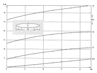
Fig. 17. Deckelwandkoppler. Leermessung 1 Blech 0,6 mm
