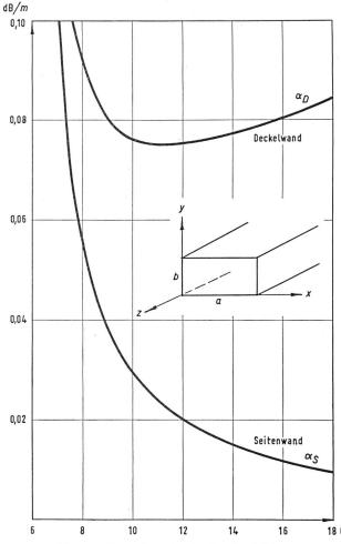
Fig. 20. Dämpfung im Rechteckhohlleiter. WR 90 Reinsilber  $\sigma = 0.615 \cdot 10^{+6} \, \varOmega^{-1} \, \, \mathrm{cm}^{-1}$
