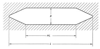
Fig. 16. Kopplungsschlitz  $L=200~{\rm mm},~m=0.70$  Krümmungsradius der Enden  $R=0.75~{\rm mm}$
