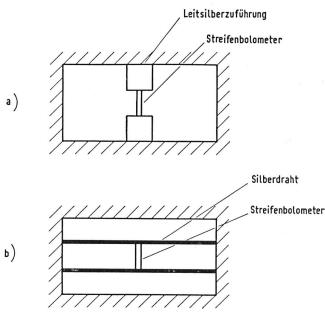
Fig. 28. Schichtdetektor im Rechteckhohlleiter
