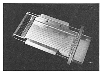
Fig. 4. Bedampfungstrog. Die zu bedampfende Glimmerfolie ist auf dem Boden des Bedampfungstroges eingespannt. Die parallelen Chrom-Nickel-Drähte (Durchmesser 0,3 mm) befinden sich 25 mm über der Glimmerfolie und verbinden die beiden Schienen für die Stromzuführung
