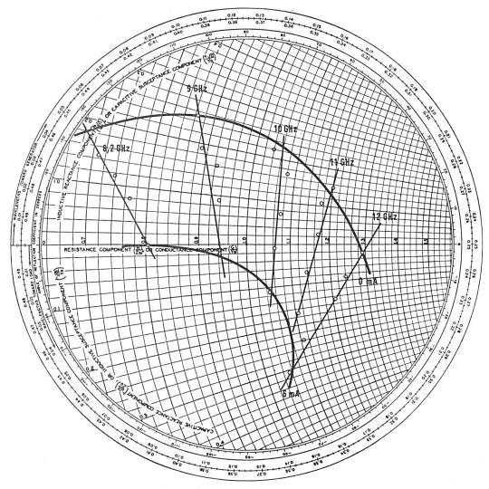
Fig. 33. Impedanz eines Schichtdetektors im X-Band.
