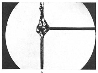
Fig. 29. Schichtdetektor mit Stromzuführung Drahtdurchmesser 50  $\mu$  Streifenlänge 3,0 mm Schichtbreite 40  $\mu$   $\star$  Stromzuführung Schichtdicke 2000 Å
