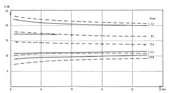
Fig. 23. Kopplungsdämpfung für Schichtkoppler  $R_F = 18,90 \ \Omega$  ----- Theorie  $\Rightarrow$  Messung
