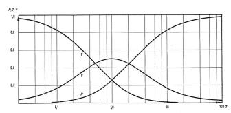
Fig. 12. Reflexion, Transmission und Verluste in einer ebenen Metallschicht
