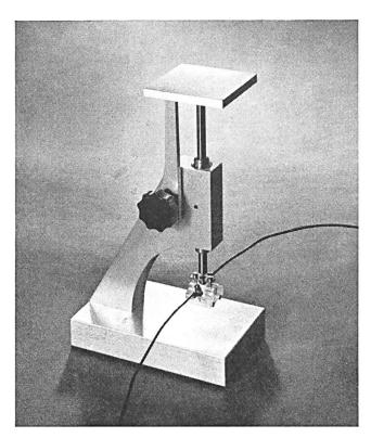
Fig. 9. Gerät zur Messung von Flächenwiderständen. Das isolierte Halterungsstück enthält zwei Rundkupferstücke, die auf die Schicht aufgepresst werden. Vom Halterungsstück führen die beiden Zuleitungen zu einer Messbrücke. Die aufgedampfte Schicht mit Träger wird auf die untere Grundplatte aufgelegt. Die Platte im oberen Bildteil kann ähnlich wie eine Briefwaage mit Zusatzgewichten beschwert werden
