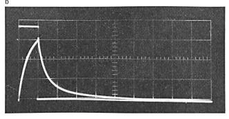
Fig. 32. Zeitkonstante eines Schichtdetektors a) Luftkühlung  $\tau = 130~\mu \mathrm{s}$
