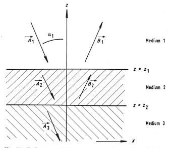
Fig. 11. Reflexion und Transmission an planparalleler Schicht
