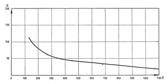
Fig. 8. Schichtdicke und Flächenwiderstand
