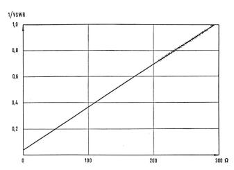
Fig. 36. Bestimmung des Wirkungsgrades eines Schichtdetektors (Grundtypus) für  $\eta=9.5~\mathrm{GHz}$
