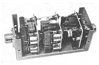
Fig. 12. Aufbau des Entzerrers (Schutzdeckel entfernt)
