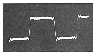
Einschwingvorgang des Nyquistmessdemodulators (250-kHz-Rechteckwechsel, Senderaussteuerung 70/50%) Fig. 10: ohne Entzerrer; Fig. 11: mit nachgeschaltetem Entzerrer
