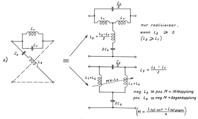
Fig. 2. Äquivalente Allpass-Schaltungen
