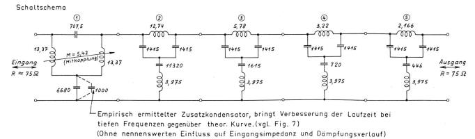
Fig. 6. Dimensionierungsdaten und Schaltschema des Entzerrers (Angaben in μH, pF)
