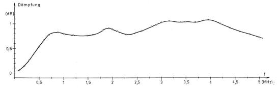
Fig. 8. Gesamtdämpfungsverlauf des Laufzeitentzerrers (Messwerte)
