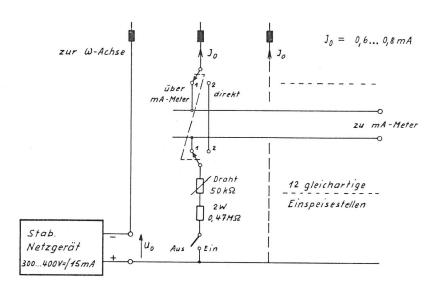
Fig. 3. Aufbau des Analogiegeräts
