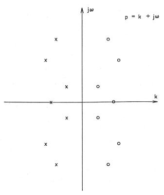
Fig. 1. Pol-Nullstellen-Konfiguration eines Allpasses in der komplexen Frequenzebene
