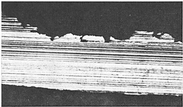
Fig. 5. Querschnitt durch den Bleimantel der bei Wilchingen verlegten blanken Kabelprobe (vgl. Fig. 1). Am Grunde der flachen Korrosionswannen hat eine interkristalline Korrosionskomponente Spalten und Einbuchtungen erzeugt.
