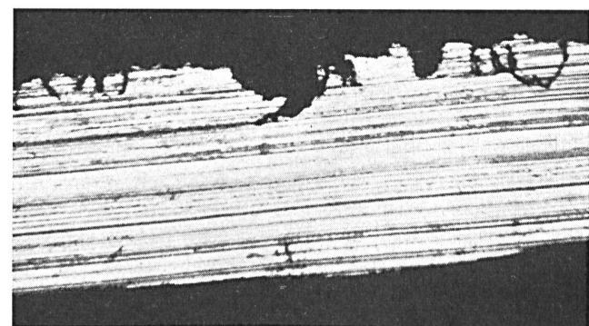
Fig. 3. Querschnitt durch den bei Frick eingegrabenen blanken Bleimantel. Die Korrosion ist längs den Korngrenzen tief in die Bleiwandung eingedrungen.
