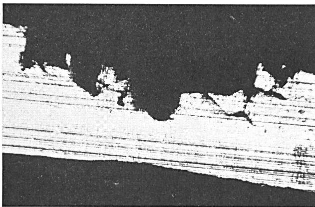
Fig. 2. Querschnitt durch eine korrodierte Stelle des blanken Bleimantels, der bei Hundwil in einem Rutschhang eingegraben worden war.
