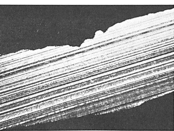
Der Umriss der Korrosionsgrube wird von einem glatten Linienzug gebildet.
