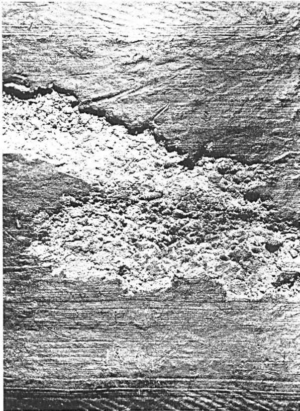
Fig. 1. Korrodierter Stelle auf der Oberfläche des bei Wilchingen blank eingegrabenen Bleimantels.
