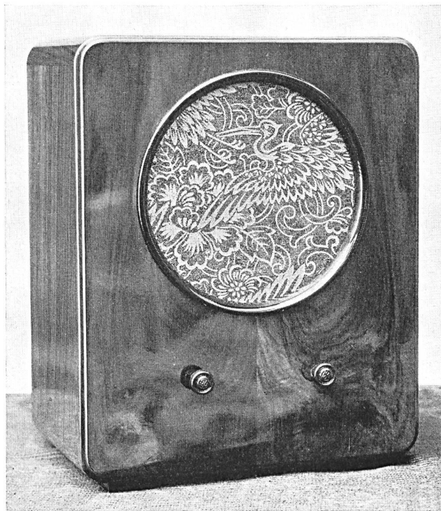
Fig. 1. Niederfrequenter TR-Apparat mit dynamischem Lautsprecher
