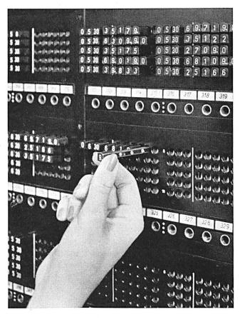
Fig. 4. Ausschnitt aus einem Markierfeld der Weckeinrichtung
