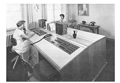
Fig. 20. Schnurlose Vermittlungseinrichtung einer modernen Teilnehmeranlage
