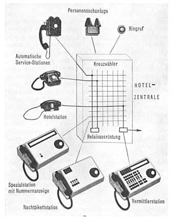
Fig. 17. Prinzip einer schnurlosen Hoteltelephonanlage
