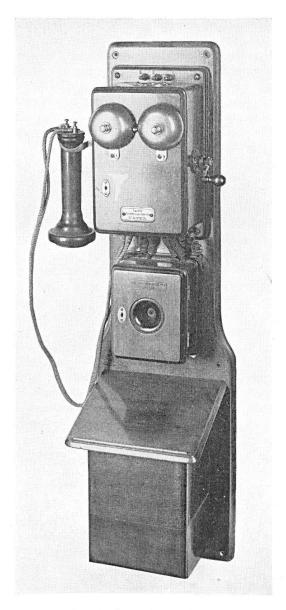
Fig. 2. Lokalbatterie-Wandstation aus dem Jahre 1881, hergestellt von der Fabrik für\_elektrische Apparate, Uster
