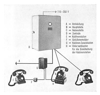
Fig. 14. Kleinautomat I/2 mit Zusatzeinrichtung für eine Kabinenstation
