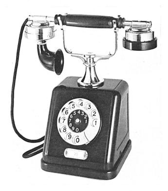
Fig. 5. Automatische Tischstation, System Siemens
