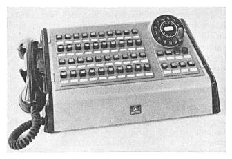
Fig. 16. Moderne Direktionsstation mit Leuchttasten
