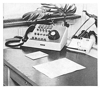
Fig. 15. Vermittlerstation einer automatischen Teilnehmeranlage
