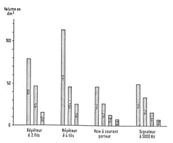
Fig. 9. Evolution de volume en dm<sup>3</sup> de divers types d'équipements au cours des années
