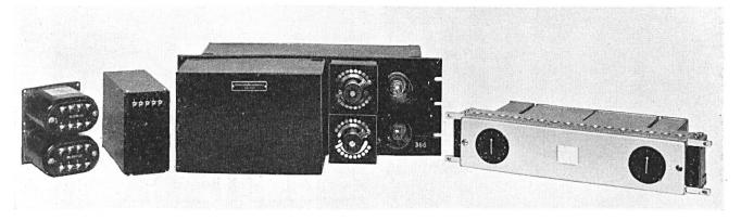
Fig. 7. Evolution du matériel des stations de répéteurs A gauche: répéteur à 2 fils d'ancien type, accompagné d'un équilibreur et d'une paire de translateurs A droite: répéteur à 2 fils moderne combiné
