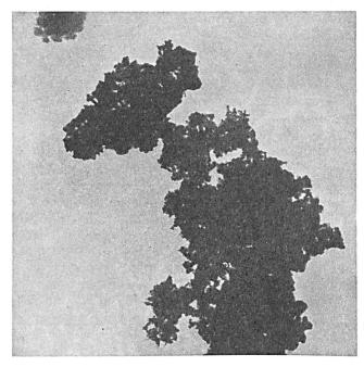
Fig. 7. Elektronenmikroskopische Aufnahmen von verdampftem Silber. Vergrösserung  $20~000\times$  a = Silberpräparat Ag 0,3; b = Silberpräparat Ag 3; c = Silberpräparat Ag 30; d = Silberpräparat Ag 3a
