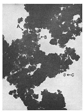
Fig. 3. Elektronenmikroskopische Aufnahmen des Kontaktpulvers. a) Vergrösserung  $4000\times$ ; b) Vergrösserung  $20~000\times$  (1 mm auf dem Bild entsprechen 0,05  $\mu$ m)
