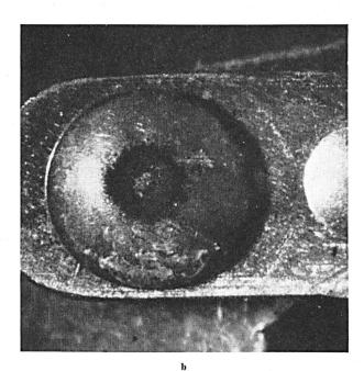
Fig. 2. Aktivierte Kontakte aus dem Betrieb mit starker ringförmiger Ablagerung von Kontaktpulver. Kontaktwiderstand  $\approx 10\,000\,\Omega$ . Vergrösserung  $25\,\times$ . a und b = zusammengehörendes Kontaktpaar
