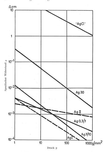
Fig. 8. Spezifischer Widerstand verschiedener Silberpulver
