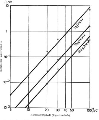
Fig. 10. Spezifischer Widerstand von Silber-Kohlenstoff-Mischungen in Abhängigkeit vom Kohlenstoffgehalt
