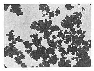
Fig. 13. Elektronenmikroskopische Aufnahme von Ruß P-33. Vergrösserung 10 000  $\times$
