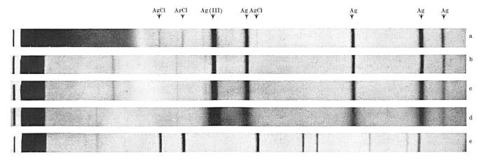
Fig. 4. Röntgenaufnahmen (Guinier-Diagramme) a = Kontaktpulver; b = Silberpräparat Ag I; c = Silberpräparat Ag II; d = Silberpräparat Ag III; e = Silberchlorid (AgCl)
