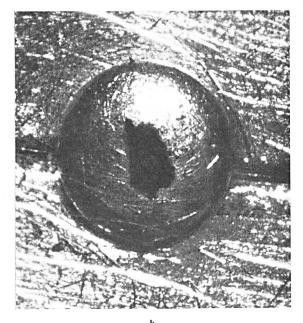
Fig. 14. Kontakte mit künstlich aufgebrachtem Ruß P-33. Vergrösserung  $25 \times$  a) Kontaktwiderstand =  $100 \Omega$  b) Kontaktwiderstand =  $300 \Omega$  (bei Kontaktlast = 20 g)
