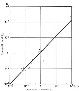
Fig. 16. Zusammenhang zwischen spezifischem Pulverwiderstand  $\varrho$  und Kontaktwiderstand  $R_K$
