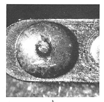
Fig. 1. Aktivierte Kontakte aus dem Betrieb mit beginnender Ablagerung von Kontaktpulver. Vergrösserung  $25 \times$ a und b=zusammengehörendes Kontaktpaar
