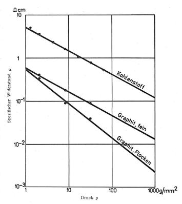
Fig. 9. Spezifischer Pulverwiderstand von Kohlenstoff und Graphit
