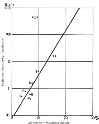
Fig. 12. Zusammenhang zwischen Wasserstoffgehalt und spezifischem Widerstand von 8 Rußsorten (bei  $p=100~{\rm g/mm^2})$
