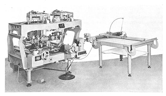
Fig. 2. Das Auswertegerät – Le stéréoautographe
