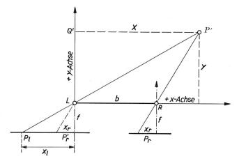
Fig. 1. Normalfall der Stereophotogrammetrie Cas normal de stéréophotogrammétrie
