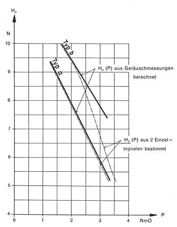
Fig. 4. Intermodulationsdämpfung von Sekundärgruppen
