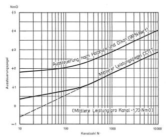
Fig. 1. Belastung bei Mehrkanaltelephoniesystemen
