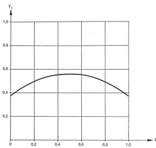
Fig. 3. Abhängigkeit des Gewichtsfaktors  $y_2$  von der normierten Frequenz
