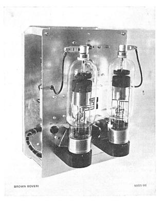
Fig. 13. Thyralux-Gerät mit zwei Thyratrons
