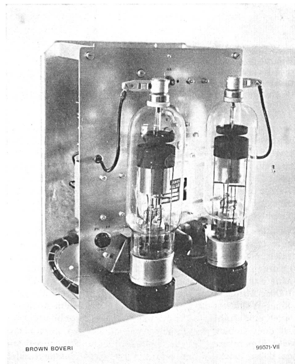
Fig. 13. Thyralux-Gerät mit zwei Thyratrons
