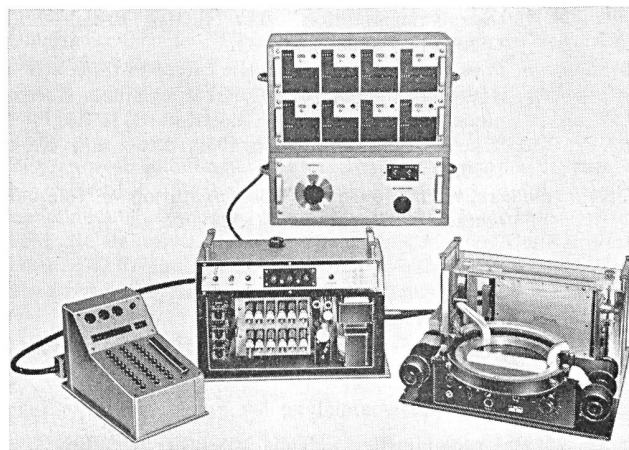
Fig. 8. Gesamtansicht des Auswertegerätes für Nachhallmessungen
