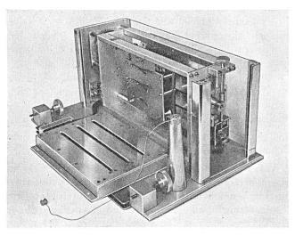
Fig. 5. Der Wandler W mit seinen drei Schleifkontakten und den abmontierten Lamellenbahnen
