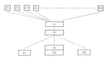
Fig. 1. Auswertegerät für Nachhallmessungen – Blockschema Appareil servant à mesurer la réverbération - Schéma-
