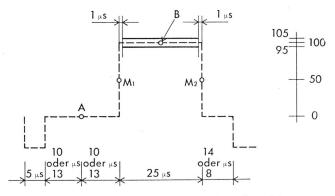
Fig. 5. Toleranzfeld für Prüfsignal Nr. 2 (zeilenzeitiger Einschwingvorgang)
