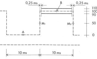
Fig. 4. Toleranzfeld für Prüfsignal Nr. 1
