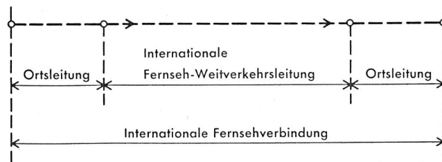
Fig. 1. Gliederung einer Fernsehverbindung
