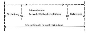
Fig. 1. Gliederung einer Fernsehverbindung
