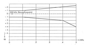
Fig. 7. Dämpfungsverlauf im eingeschwungenen Zustand (keine Pflichtforderung!)
