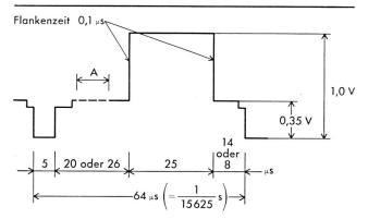
Fig. 10. Prüfsignal Nr. 2
