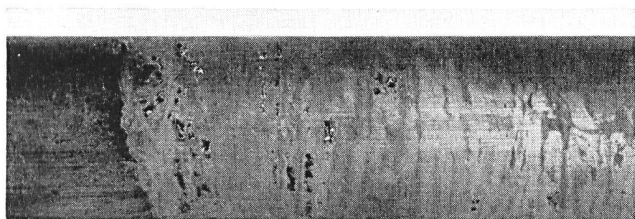
Fig. 24. und Fig. 25. Korrosionsspuren auf der Bleioberfläche unter den Hanfgarnen bei Proben, die mit Imprägnieröl begossen worden waren und teilweise in dem Teeröl standen. Die Korrosionen entstanden hauptsächlich am Ende der Wicklung, die nicht eingetaucht war, also
