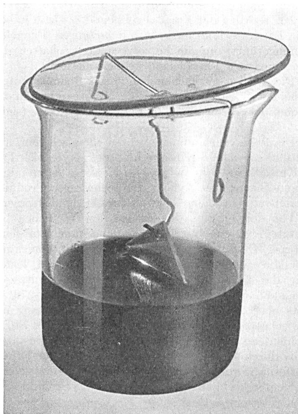
Fig. 1. Versuchsanordnung mit halbeingetauchten Bleiprobe
