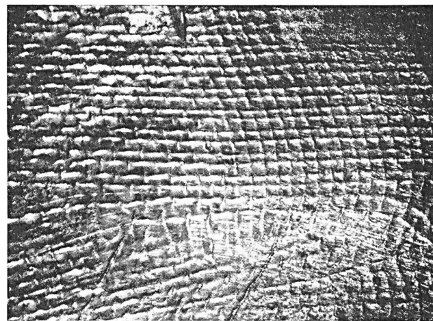
Fig. 29. Bei einer umwickelten Bleielektrode sind auf der Oberfläche, soweit diese aus dem Elektrolyten (Xylenol) herausragte, Korrosionsfiguren entstanden, welche die Lage der einzelnen Fäden des Baumwollbandes deutlich abbilden. Versuchsdauer 20 Tage bei Zimmertemperatur Vergrösserung 4×
