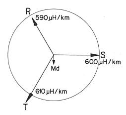
Fig. 3. Gegeninduktivität zwischen den drei Phasen einer symmetrisch belasteten Drehstromleitung und einer Leitung mit Erdrückleitung im Abstand x vom mittleren Phasenseil Md= Resultierende Gegeninduktivität
