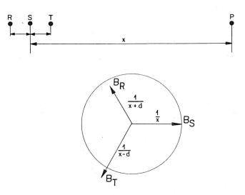
Fig. 2. Induktion (B) der drei einzelnen Phasen einer symmetrisch belasteten Drehstromleitung im Abstand x vom mittleren Phasenseil
