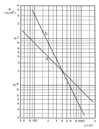
Fig. 1. Vertikalkomponente des magnetischen Feldes einer Leitung Kurve a) Kurve b) Leitung mit Erdrückleitung, Erdstrom 40 A Dreiphasenleitung mit Leiteranordnung auf horizontaler Ebene, Phasenabstände 10 m, symmetrische Belastung von 930 A pro Phase
