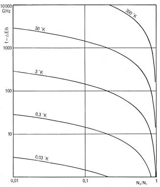
Fig. 10. Boltzmannsches Verteilungsgesetz für verschiedene Temperaturen
