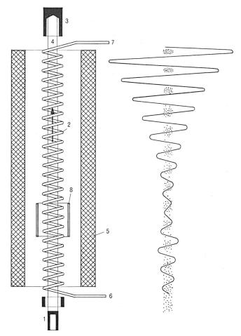
Fig. 6. Schematische Darstellung einer Wanderfeldröhre. Verstärkung der elektromagnetischen Welle längs des Helix und Bildung des dichtemodulierten Elektronenstrahls Legende:
