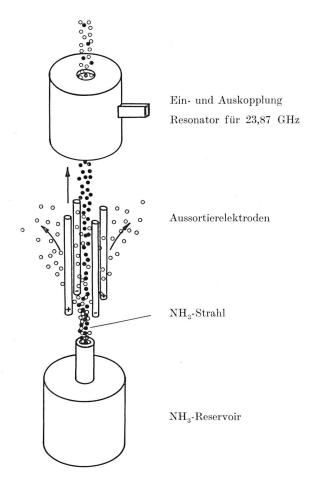
Fig. 8. Schema des Ammoniakstrahlmasers. Von den Molekülen werden jene mit dem niedrigen Energieniveau nach aussen abgelenkt. Der Strahl mit den Molekülen im höheren Zustande gibt seine Überschussenergie im Resonator ab Legende:
