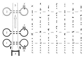
Fig. 4. Vereinfachte schematische Darstellung der Wirkungsweise eines Klystronverstärkers. Die Bildung von Elektronenpaketen (Phasenfokussierung) im Laufzeitraum ist aus den «Momentaufnahmen» des Elektronenstrahls in aufeinanderfolgenden Zeitpunkten ersichtlich Legende:
