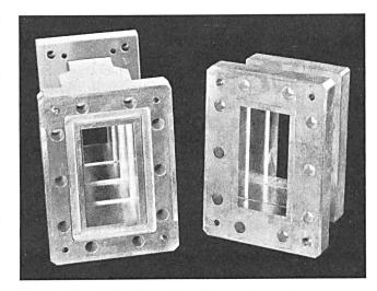
Fig. 3. Hohlleiter-Impedanztransformatoren  $(29 \times 58 \text{ mm}, \text{ für den GHz-Bereich})$
