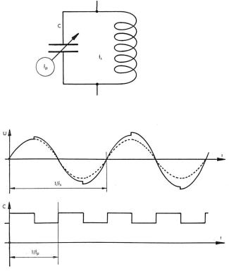
Fig. 11. Prinzip eines einfachen parametrischen Verstärkers. Die Kapazität C wird im Takt der Pumpfrequenz verändert
