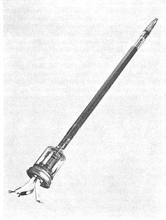
Fig. 7. Wanderfeldröhre (Standard Telephone and Cables) für 4 GHz
