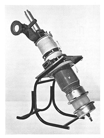
Fig. 5. Hochleistungs-Klystron, hergestellt an der Stanford University
