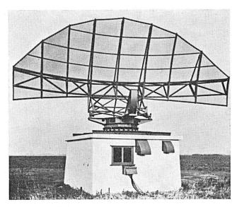
Fig. 12. Überwachungs-Radaranlage eines Flugplatzes
