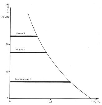
Fig. 9a. Boltzmannsche Verteilung der Besetzungszahlen für verschiedene Energiezustände (Thermodynamisches Gleichgewicht)
