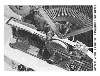
Fig. 1. Fernschreibmaschine mit Streifenschneidevorrichtung Téléimprimeur avec dispositif à couper les bandes
