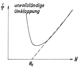
Fig. 3. Umklappgeschwindigkeit Legende:
