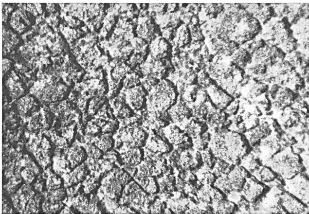
Fig. 31. Gleiche Probe wie bei Figur 30; Salzkruste mit 2n Essigsäure entfernt. Interkristalline Korrosion auf der Oberfläche der eingetauchten Hälfte des Bleiblechs.
