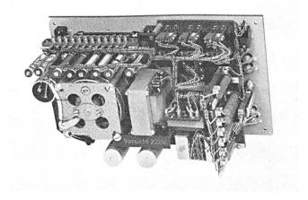
Fig. 2. Verzerrungsmesser Tfg 5–85.317 (Innenansicht). Links im Bild der Aussenläufer-Synchronmotor
