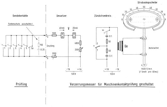
Fig. 6. Vereinfachtes Prinzipschema des tragbaren Verzerrungsmessers
