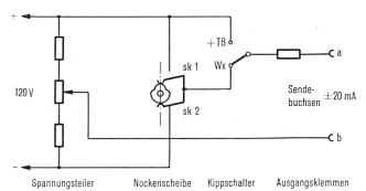
Fig. 3. Sendestromkreis für Doppelstrom-Prüfwechselimpulse
