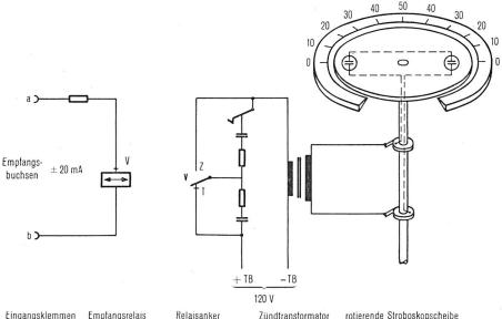
Fig. 4. Empfangsstromkreis für Doppelstromimpulse ± 20 mA
