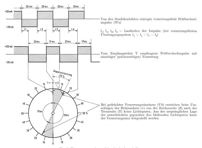
Fig. 5. Verzerrungsanzeige auf der Stroboskopscheibe
