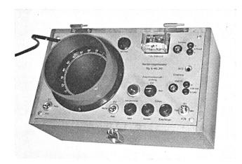
Fig. 1. Verzerrungsmesser Tfg 5–85.317. (Aussenmasse  $2\,80\times170$   $\times165\,$  mm)
