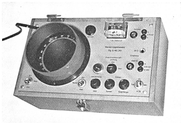
Fig. 1. Verzerrungsmesser Tfg 5-85.317. (Aussenmasse 280 × 170 × 165 mm)
