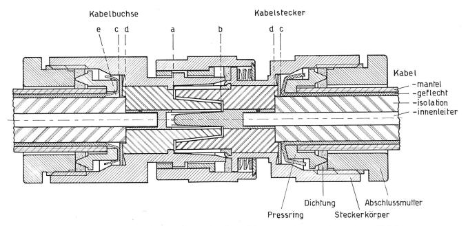
Fig. 2. Schnittzeichnung einer zusammengesteckten C-Steckerkombination mit montierten Kabeln
