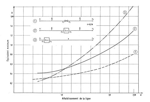
Fig. 17 Equivalent minimum de la ligne 1 avec répéteur à deux fils
