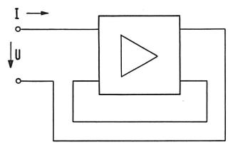
Fig. 16. Réaction positive en tension (Répéteur E<sub>3</sub>)
