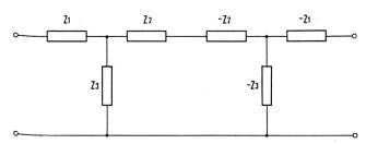
Fig. 11. Réseaux en T avec impédances positives et négatives
