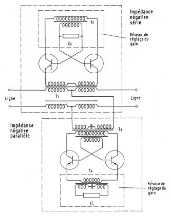
Fig. 18. Schéma d'un répéteur à impédances négatives série/parallèle
