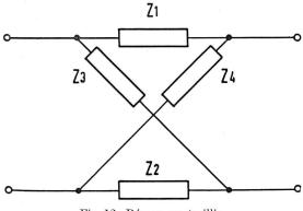
Fig. 12. Réseau en treillis
