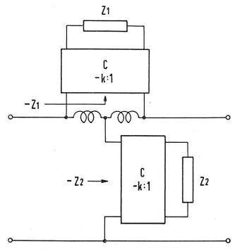
Fig. 14. Principe d'un répéteur à impédances négatives série/parallèle ( $\mathbf{E}_{z3})$
