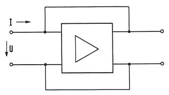
Fig. 15. Réaction positive en courant (Répéteur E<sub>2</sub>)
