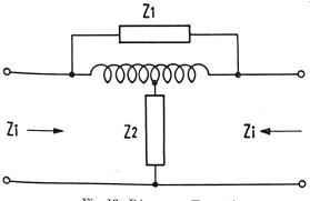
Fig. 13. Réseau en T ponté
