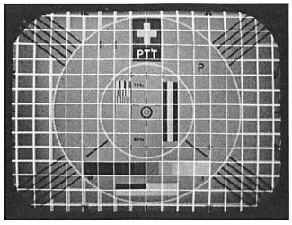
Fig. 3. Testbild mit überlagertem elektronischem Liniengitter zur Kontrolle der Ablenkgeometrie eines Bildgebers
