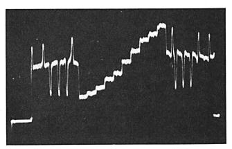
Fig. 5. Oszillogramm einer Zeile mit der Grautreppe (N)
