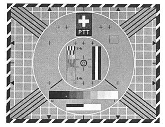
Fig. 1. Testbild des schweizerischen Fernsehnetzes
