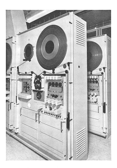
Fig. 2. Sprechmaschinen für die Ansagen
