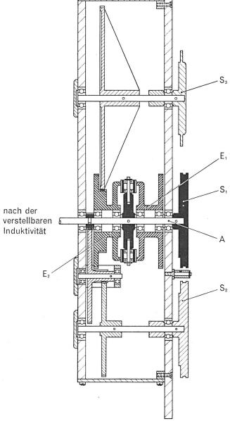
Fig. 7. Differentialgetriebe im Schnitt
