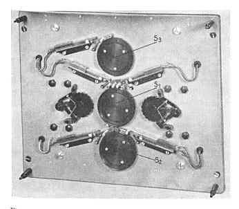
Fig. 6. Synchronisiervorrichtung mit Schrittschaltwerken und Steuerscheiben
