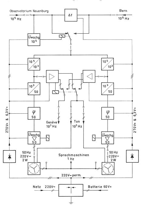
Fig. 8. Blockdiagramm des Zeitsignalgebers
