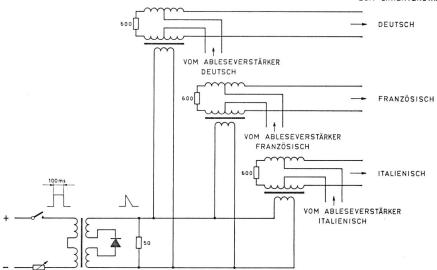
Fig. 9. Schaltung zur Superposition zusätzlicher Zeitmarken auf die Ansagen
