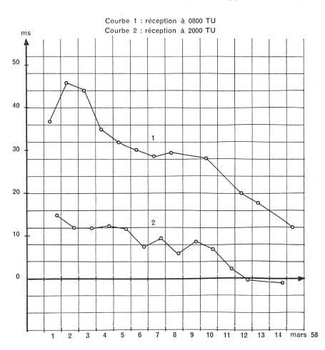
Fig. 12. Graphique des états des tops de VHP 2 12 908,5 kHz par rapport à l'horloge directrice, à leur réception à Neuchâtel
