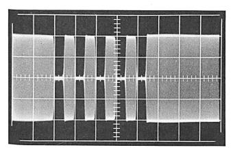
Fig. 8. Enveloppe du top-seconde de HBN lors de son émission. Vitesse de balayage  $2~\mathrm{ms}$  par division
