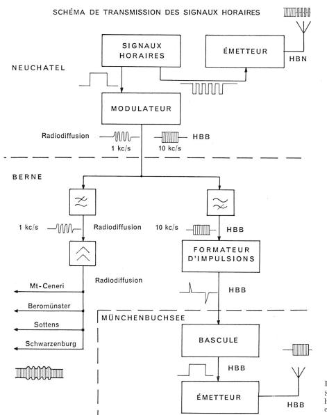
Fig. 6. Schéma de transmission des signaux horaires entre l'Observatoire de Neuchâtel et les différents émetteurs
