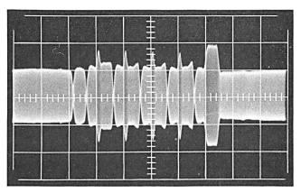
Fig. 10. Réception de HBN à la Vue-des-Alpes. Interférence destructive sauf pour la dernière impulsion, entre deux ondes de modes de propagation différents. Vitesse de balayage 2 ms par division
