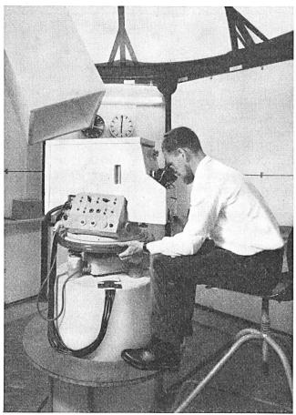
Fig. 2. L'astrolabe Danjon de la station de la Vue-des-Alpes. Cet instrument permet d'observer le passage des étoiles à 60° au-dessus de l'horizon. Comme la lunette zénithale photographique, l'astrolabe permet la détermination simultanée de l'heure et de la latitude
