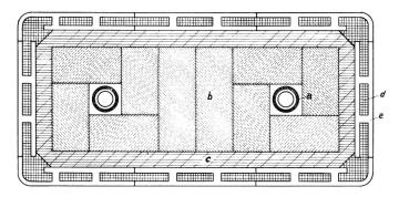
Fig. 4. Schnitt durch einen modernen Speicherofen
