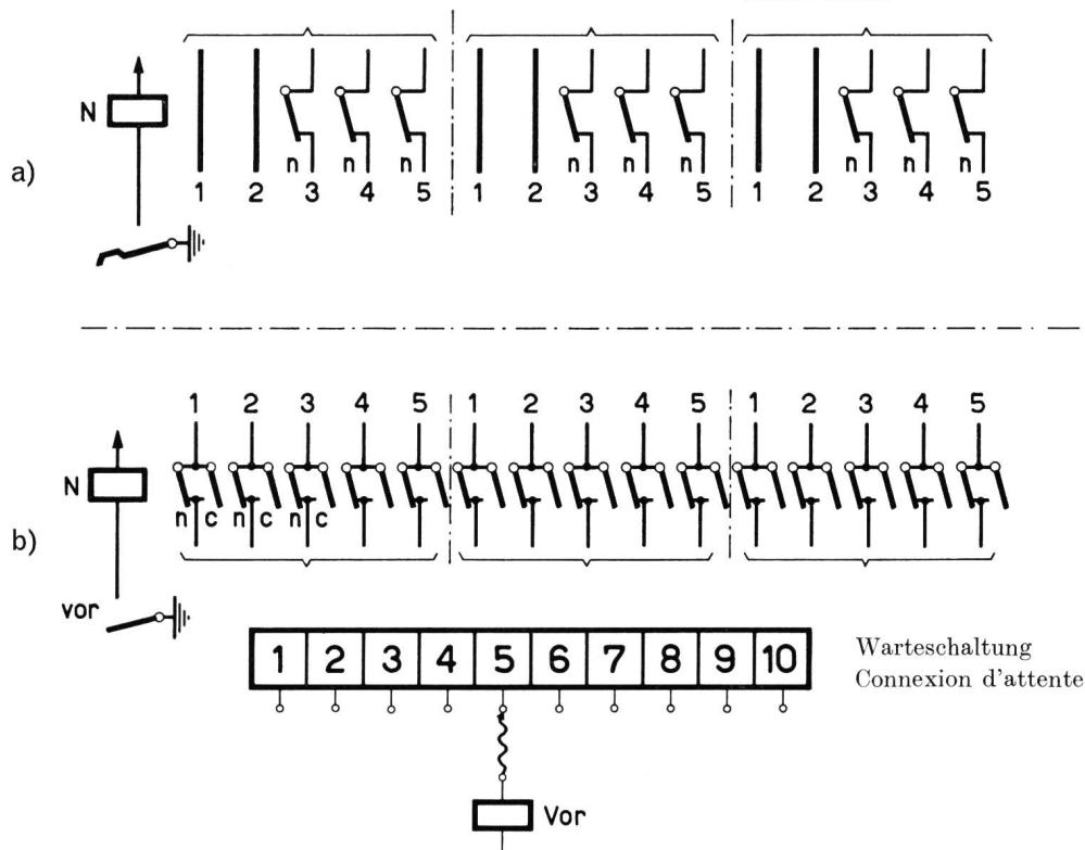
Fig. 11. Reduktionsschaltung für die Leitungen Nr. 12 im Zwischendienst (12–14 Uhr, nach 18 Uhr) und sonntags
