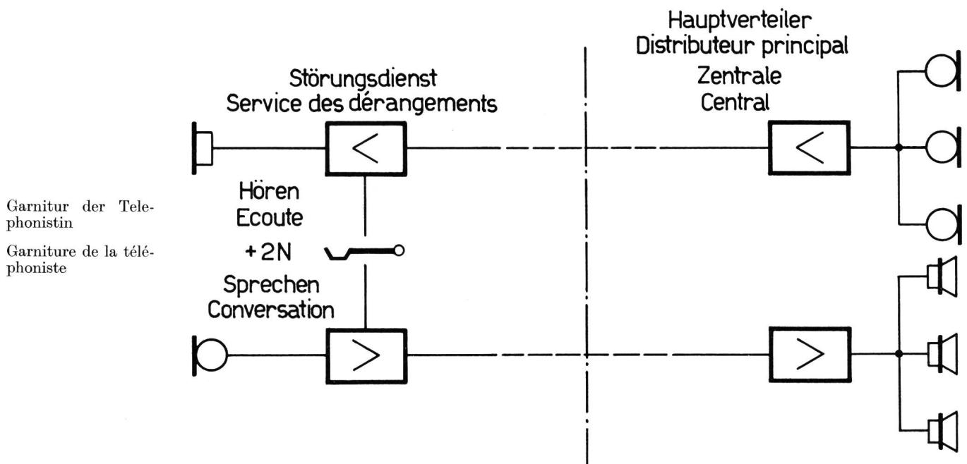
Fig. 17. Gegensprechanlage – Installation d'intercommunication par haut-parleurs
