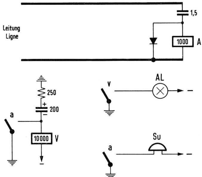
Fig. 15. Anrufschaltung für Leitungen mit Wechselstromruf Connexion d'appel pour lignes à courant d'appel alternatif
