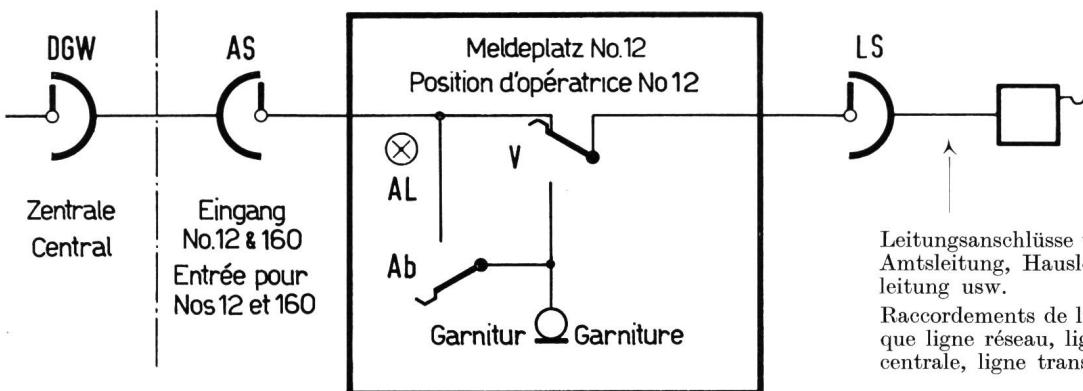
Fig. 12. Eingangsaggregate für die Leitungen Nr. 12 und 160 (Prinzipschaltung)
