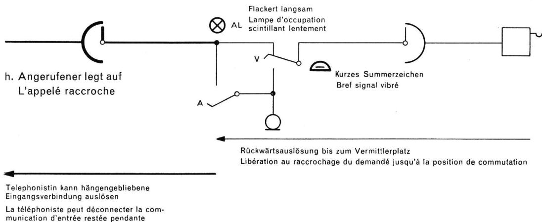
Fig. 13 (S. 490...491) Verschiedene Betriebszustände der Eingangsaggregate – Diverses positions de service des agrégats d'entrée
