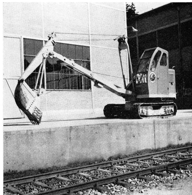
Fig. 2. Normaler Tieflöffelbagger
