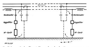
Schematische Darstellung des Ausbreitungsvorganges bei Einphasenkopplung. Über die Streukapazität der nicht eingekoppelten Phasen bildet sich der Rückweg. Infolge der grossen Verluste bildet sich der Rückweg längs der Erde praktisch nicht aus
