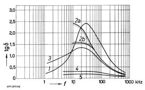
Fig. 6. Änderung des Verlustfaktors tg  $\delta$  von Eis und von verschiedenen Formen von Rauhreif und Schnee (Temperatur
