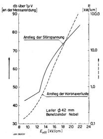
Fig. 2. Anstieg der HF-Störspannung und der Korona-Verluste  $P_{\nu}$  für einen bestimmten Leiter in Funktion der Feldstärke E an der Leiteroberfläche.
