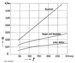
Fig. 3. Verlauf der kilometrischen Dämpfung in Funktion der Frequenz. Die angegebenen Werte sind als Richtgrössen zu bewerten und in gewissen Grenzen noch vom Leiterdurchmesser abhängig.  $\alpha$  Dämpfung; f Frequenz
