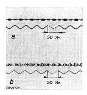
Fig. 4. Zeitlicher Verlauf der Korona-Störspannung in Funktion der Leiterspannung.
